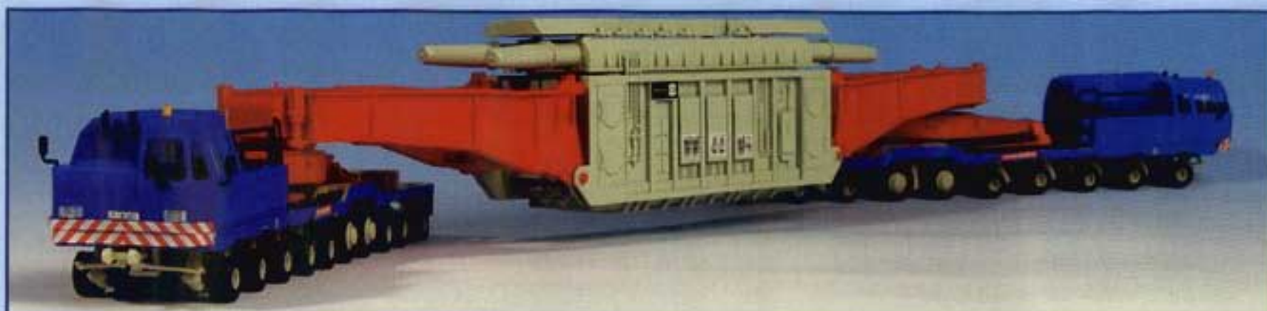
B-13583 Schwerlastselbstfahrer mit Transformator
